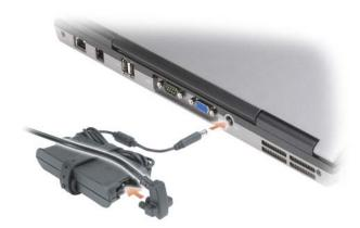
El adaptador de CA convierte la corriente alterna en la corriente continua que necesita el equipo. Puede conectar el adaptador de CA al equipo independientemente de que esté encendido o apagado.
