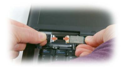
**6** Desconecte la tarjeta del cable y extráigala del equipo.
